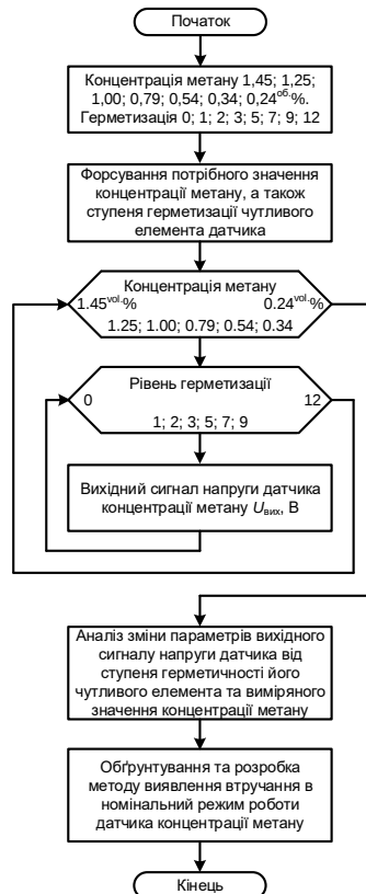
Рис. 1. Блок-схема алгоритму дослідження впливу втручання на роботу датчиків концентрації метану
