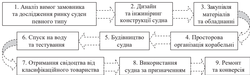
Рис. 1. Етапи процесу створення вартості судна
