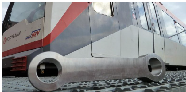
Рис. 6. Ланка гальмівної підвіски для гальмівного агрегату метро виготовлена за допомогою АМ
