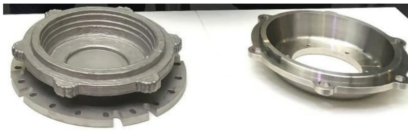
Рис. 2. Кришка підшипника колісної пари, надрукована на 3D-принтері за технологією WAAM
