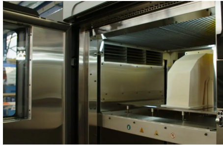
Рис. 7. Компонент системи вентиляції, надрукований з використанням технології 3-D друку
