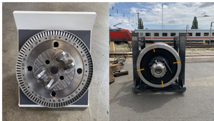
Рис. 5. Роздруковані на 3D-принтері лопасті турбіни (ліворуч) і кришка підшипника колісної пари (праворуч)
