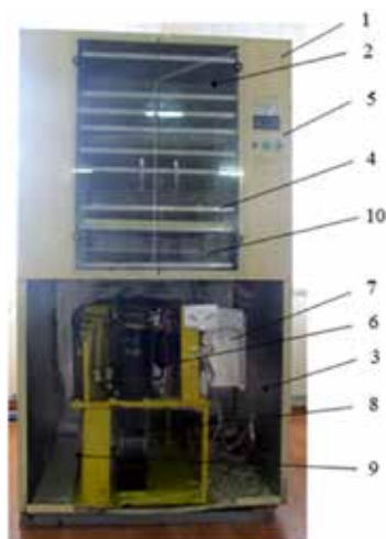
Рис. 7. Теплонасосна сушильна установка: 1 – корпус сушарки; 2 – сушильна камера (технологічний відсік); 3 – агрегатний відсік; 4 – піддон; 5 – пульт керування сушарки; 6 – теплонасосний агрегат; 7 – рекупераційний теплообмінник; 8 – циркуляційні вентилятори; 9, 10 – стартовий електронагрівач
